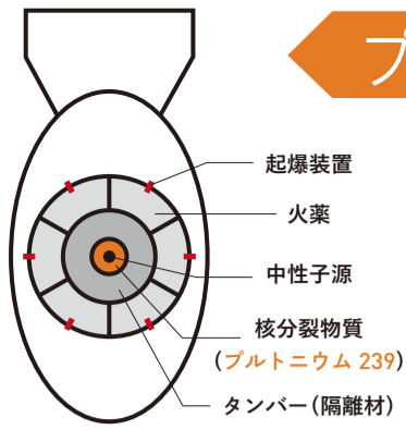
長さ3.25m 直径1.52m 重さ4.5ト TNT火薬換算21キロに相当 「ファットマン(ふとっちょ)」と呼ばれた
